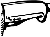
PARA APAGAR LA HERRAMIENTA (POSICION "OFF"): Deje de ejercer presión sobre la palanca de paleta. El interruptor está accionado por resorte y volverá a la posición "OFF" automáticamente.
