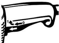
POUR METTRE L'OUTIL AU REPOS: Relâchez la palette. L'interrupteur, qui est à ressort, retournera automatiquement à la position d'arrêt.
